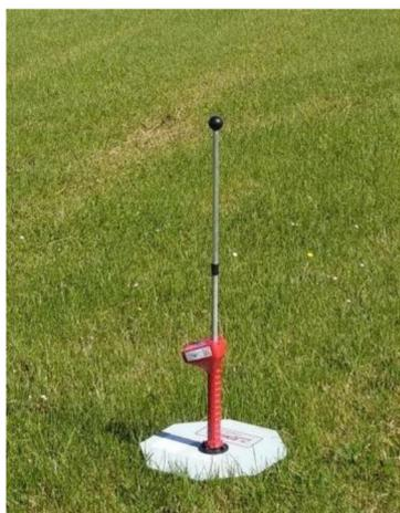
*Herbomètre connecté Jenquip utilisé pendant les suivis en ferme.*
